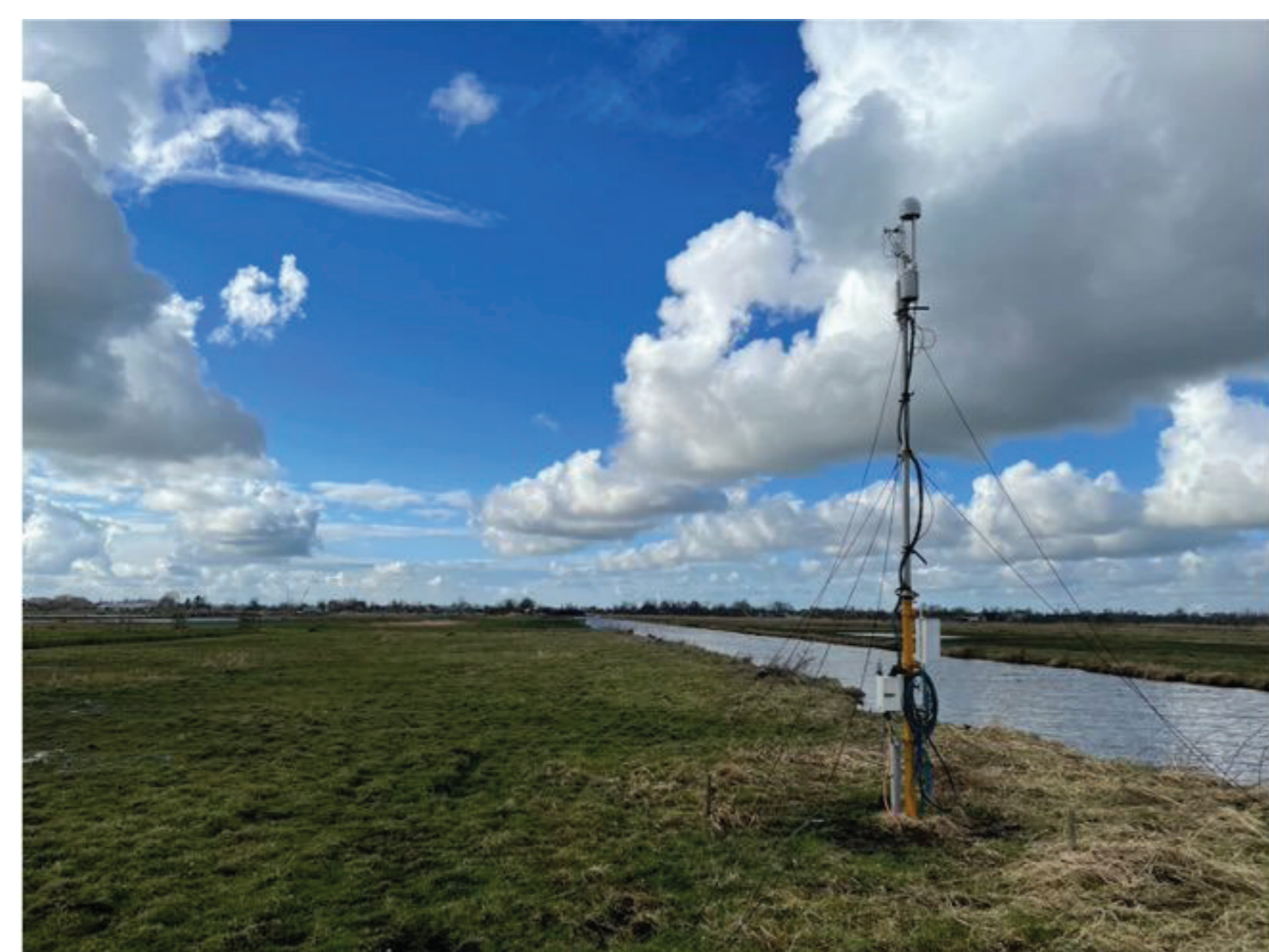
Figuur 1. Eddy Covariance meet set up op locatie
